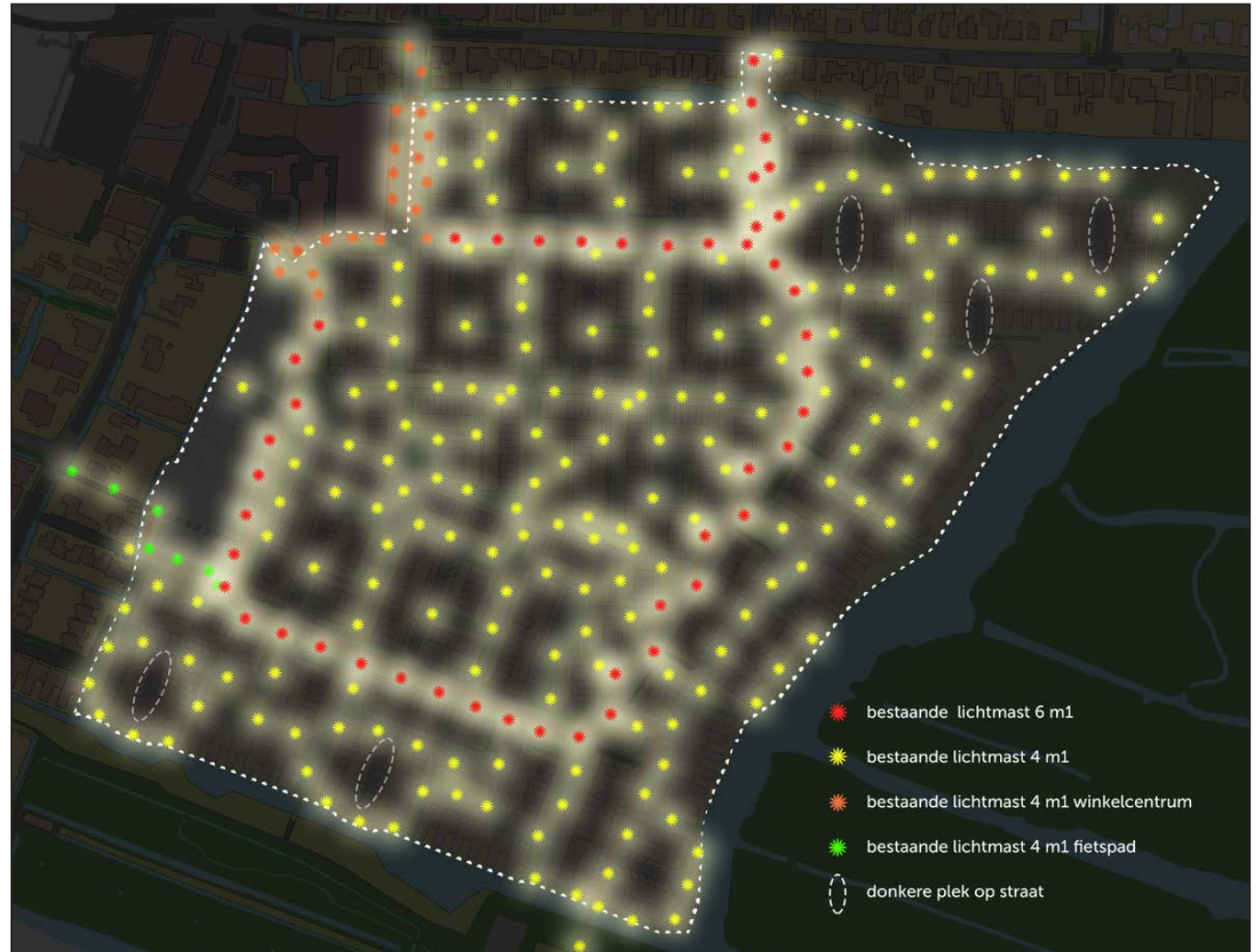
overzicht van verlichting in Havenzathe en indicatie van 'donkere plekken
